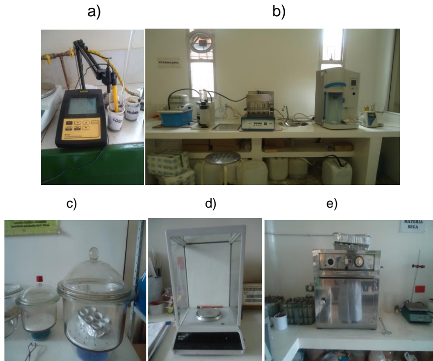
a) Análisis de pH. b) Equipo de análisis de nitrógeno total. c) Desecador. d) Balanza analítica. e) Mufla.
