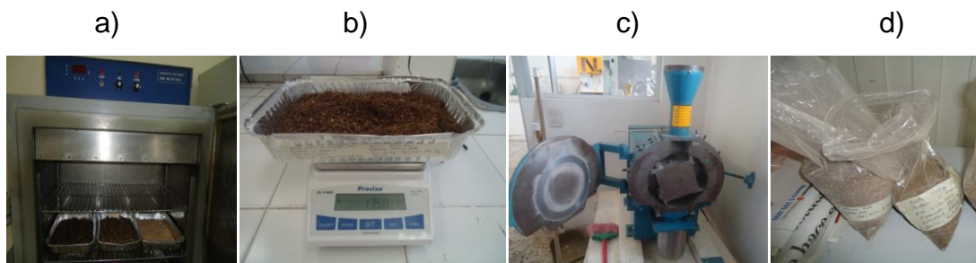
a) Secado de muestras. b) Pesaje de muestras. c) Molino d) Muestras secas y molidas para analizar.
