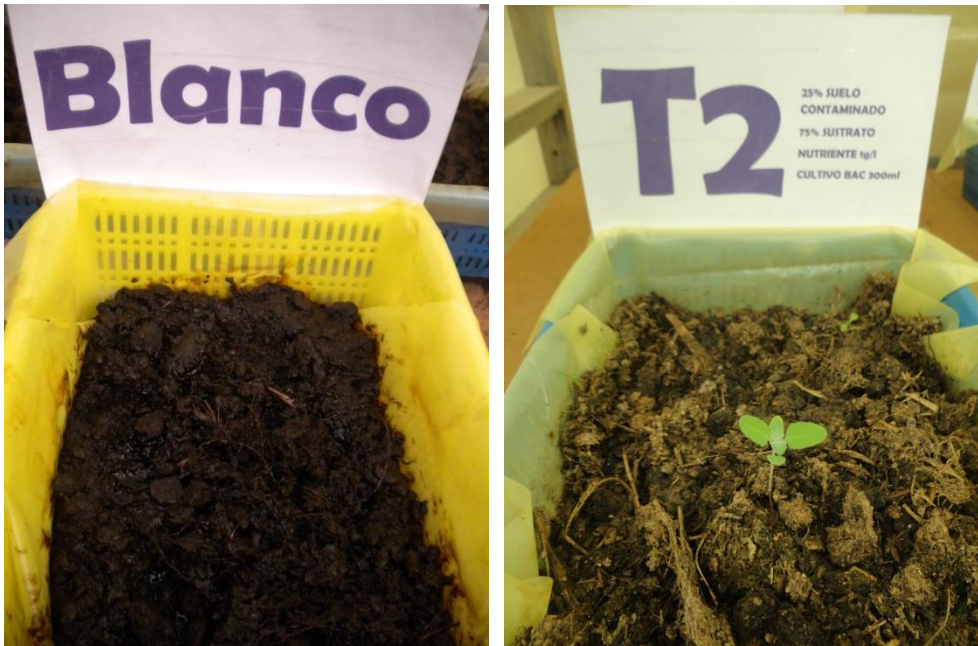
Fotografía 3 y 4. Suelo contaminado (Blanco) y suelo en tratamiento
