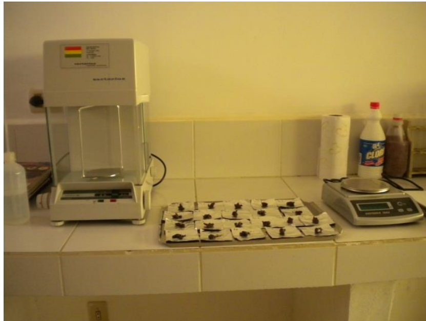
Fotografía 11 y 12. Análisis de porcentaje de humedad y análisis de pH
