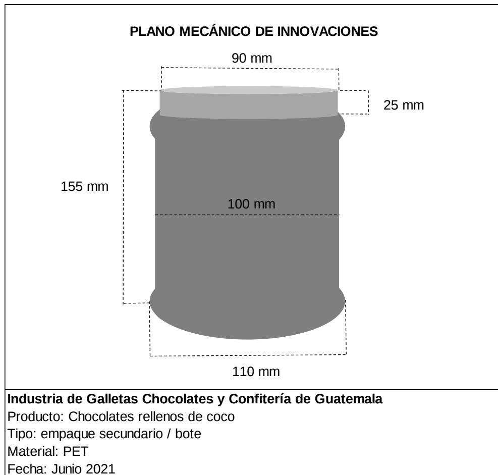
Figura 13. Plano mecánico empaque secundario chocolate relleno de coco
