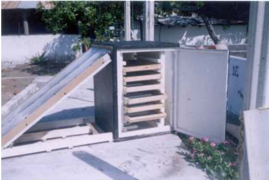
Figura 39. Vista de ensayos con secador solar tipo chimenea
