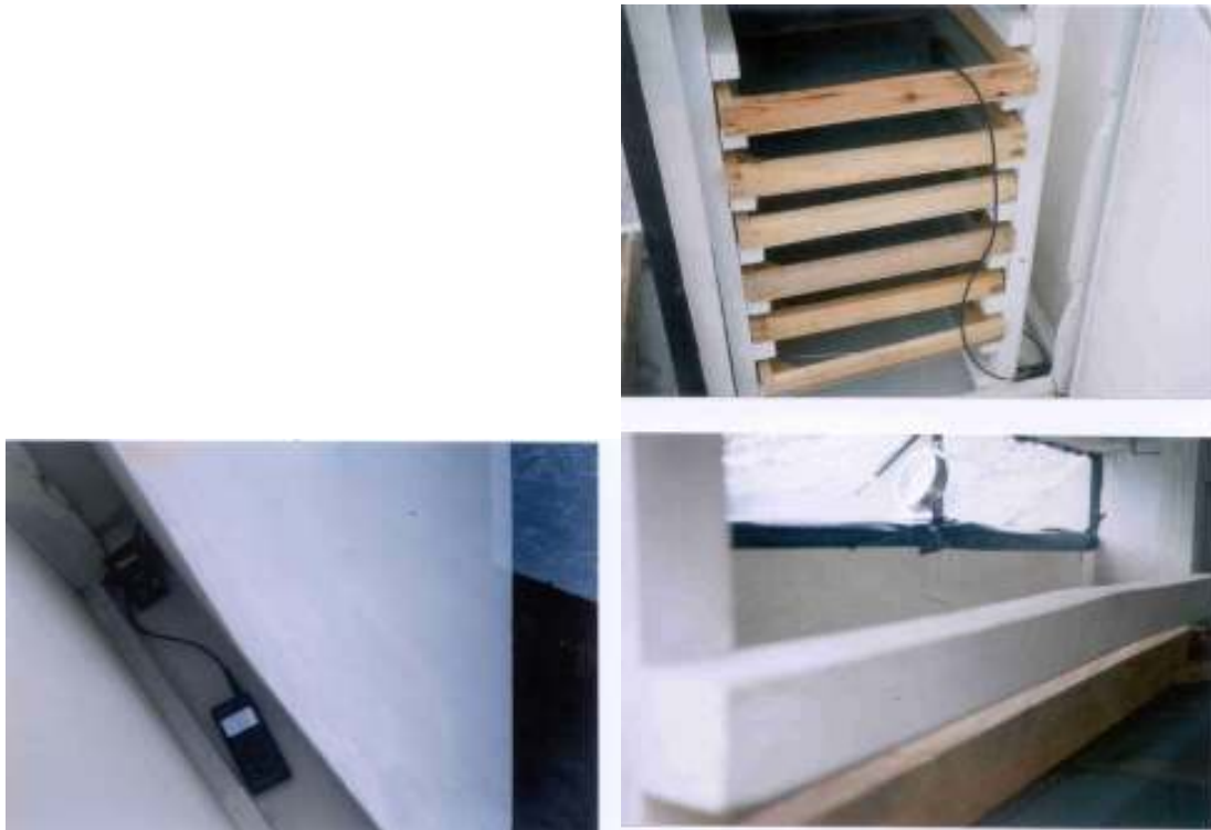
Figura 41. Fotografías de la ubicación de los termómetros en el interior del secador solar tipo chimenea
