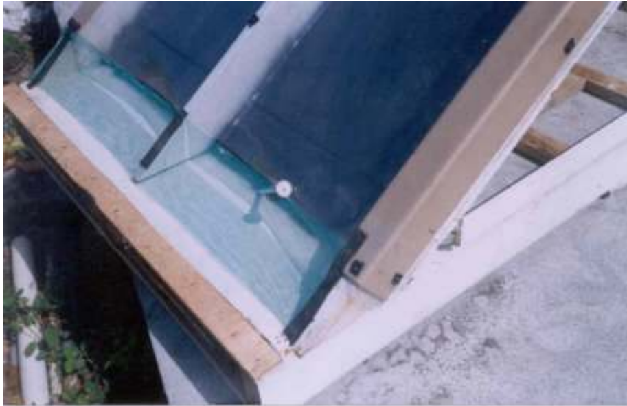
Figura 40. Instrumentos para mediciones externas del secador solar
