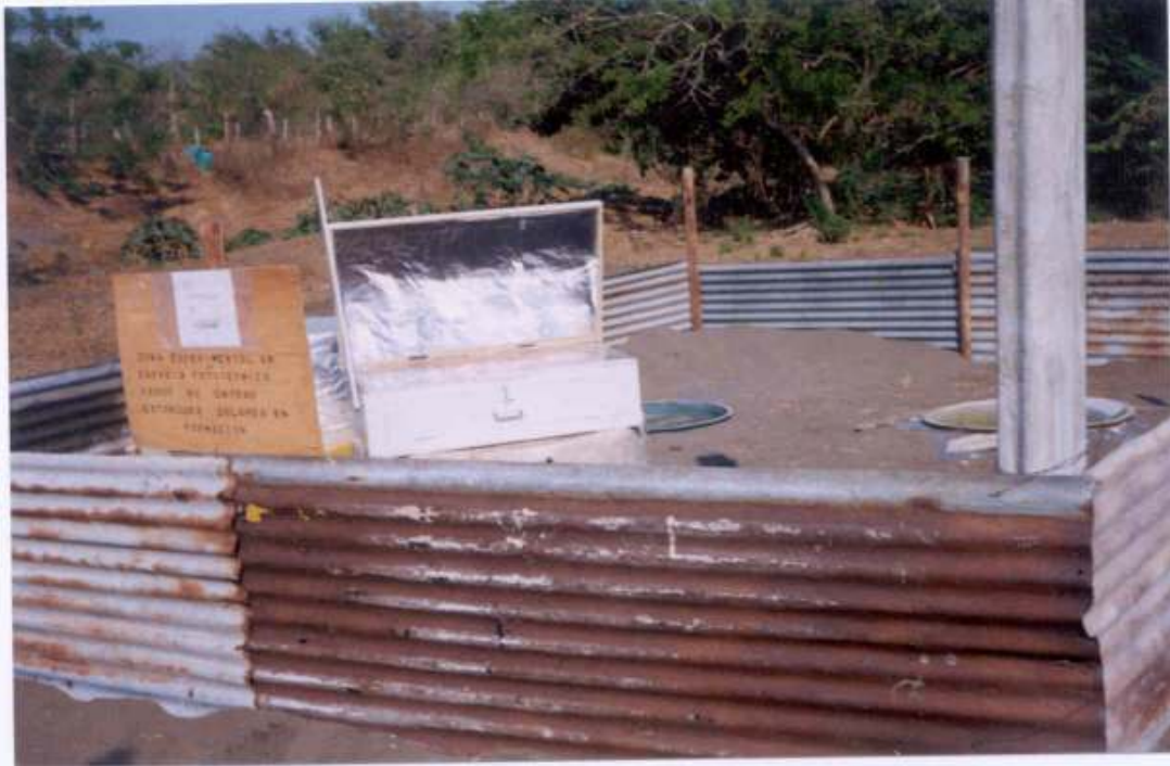
Figura 34. Vistas del horno solar tipo caja con reflector en operación
