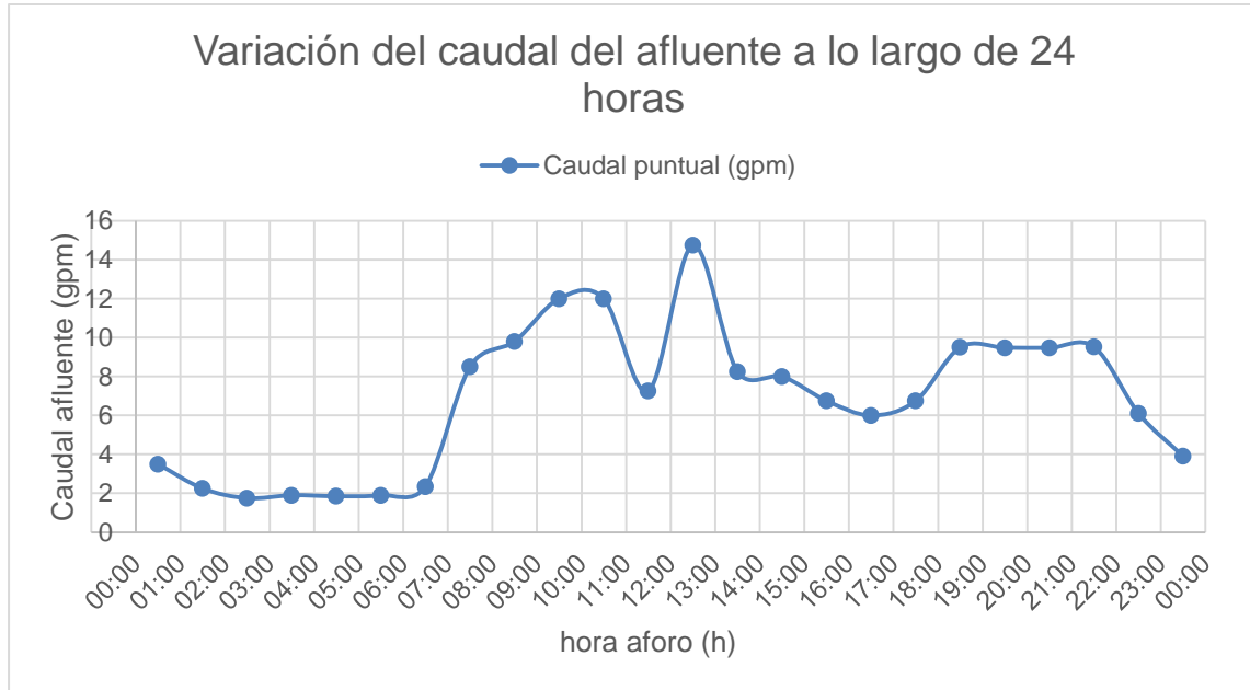
Figura 17. Gráfica de comportamiento de caudal vs tiempo en un día de operación municipal
