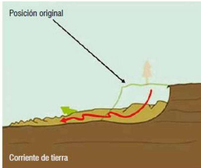
Figura 8. Esquema de corriente de tierra
