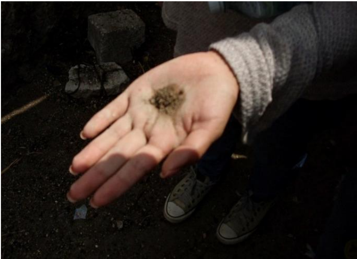
Figura 15. Ensayo de dilatancia del material del suelo del talud
