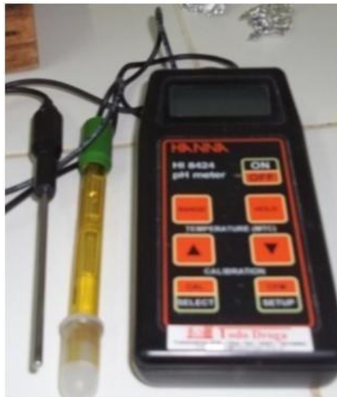
Figura 7. pHmetro portátil modelo Hanna HI 8424
