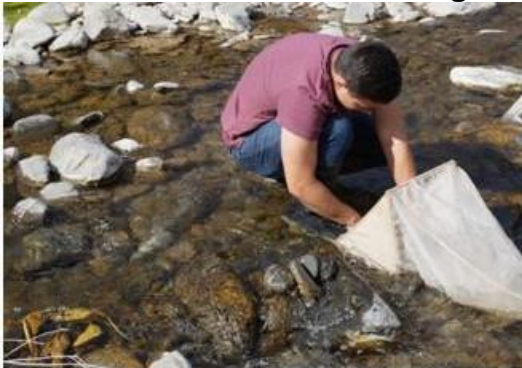
Muestreador tipo Surber para obtención de muestras biológicas
