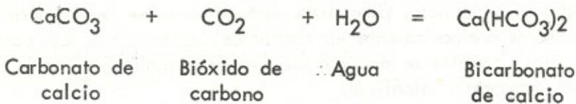
Los requerimientos de productos químicos y los resultados de la suavización difieren respecto a las durezas de carbonatos y de no-carbonatos, así como también en cuanto a las durezas de calcio y magnesio.
