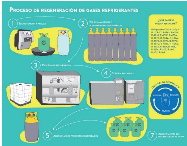
Figura 12. Proceso de regeneración de gases refrigerantes
