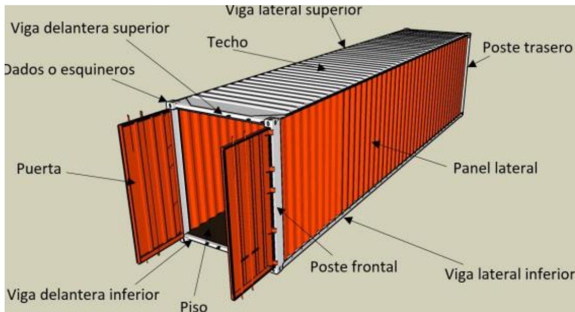
Figura 17. Partes del contenedor
