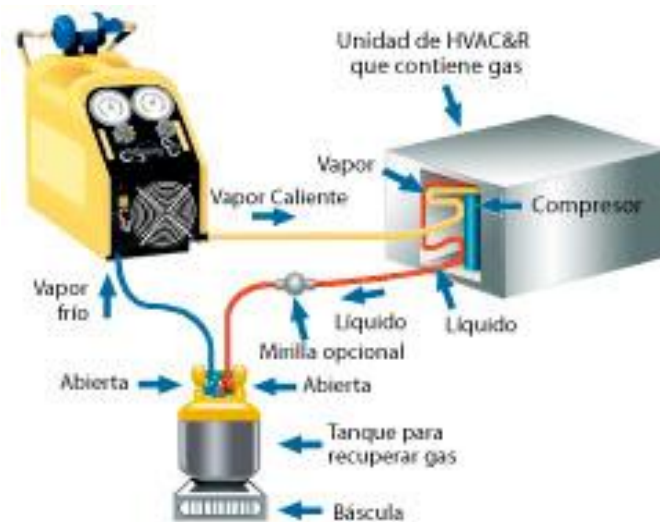
Figura 8. Recuperación por método push/pull
