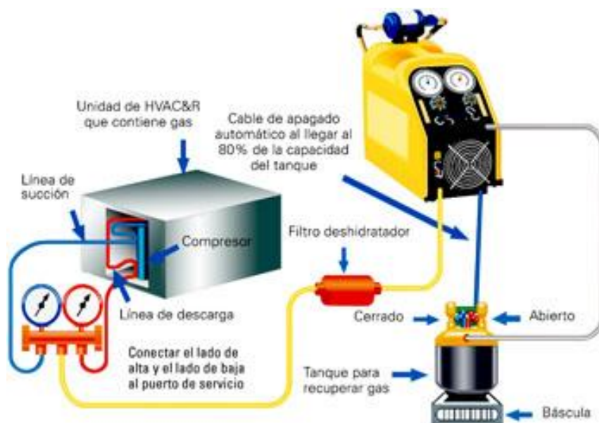
Figura 10. Recuperación en conexión líquido y vapor
