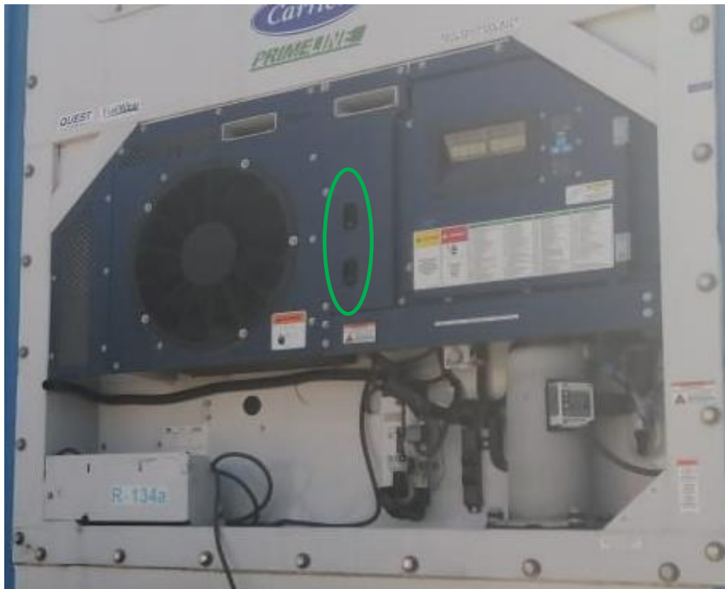
Figura 29. Ubicación de cristales en el sistema de refrigeración
