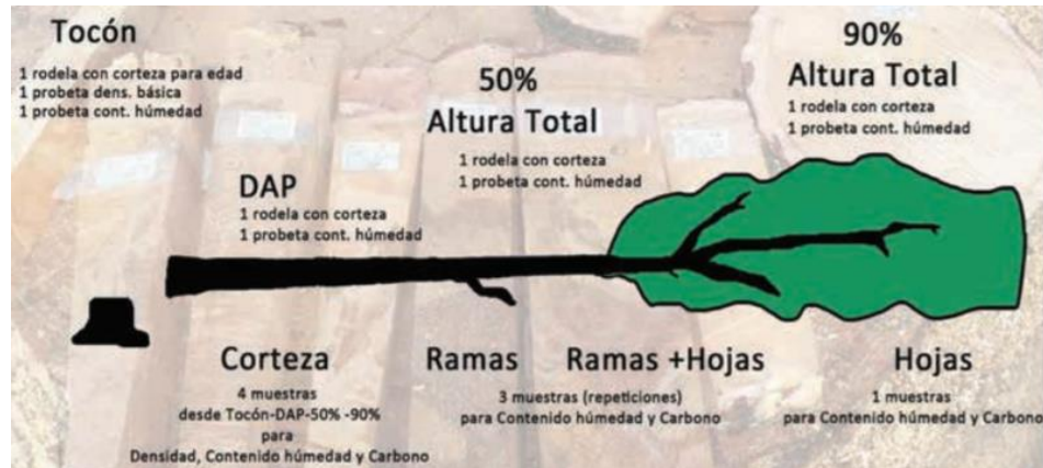
Figura 4. Método directo o destructivo, toma de muestras
