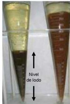
La extracción de los lodos del reactor debe realizarse finalizado el período de sedimentación y después de evacuar el agua clarificada. Para ello, coloque la bomba sumergible al fondo del reactor y dirija los lodos hacia el digester de lodos.
