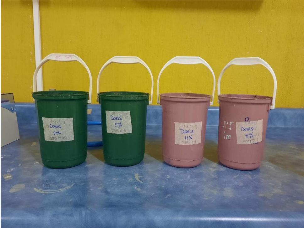
Recipientes de lodos residuales mezclados con hidróxido de calcio o cal hidratada a dosis de 2, 5, 7 y 11 %, en base húmeda.
