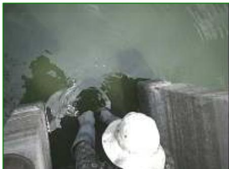
**Figura 5.2** Toma de muestras para análisis físico-químico en las lagunas de estabilización
