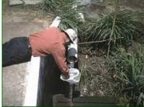
**Figura 5.5** Aforo Volumétrico en el punto de la base aérea del sur
