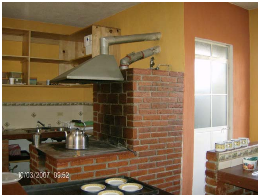
Figura 07 Modelo de estufa de leña integral. Estufa, calentador de agua y extractor de olores
