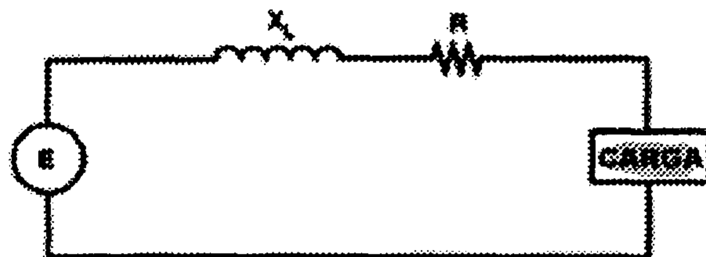
Figura 17. Modelo de la transformada de la impedancia de primer orden
