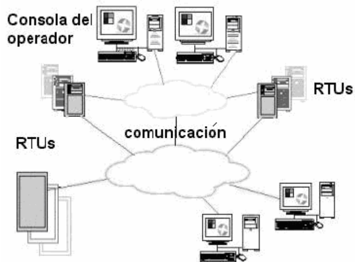
Figura 5. RTU's conectadas con la estación maestra
