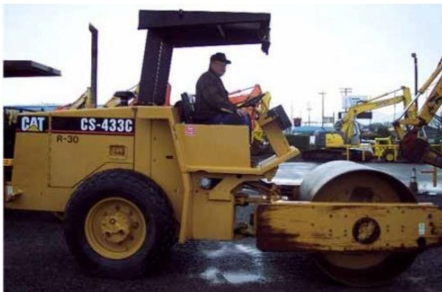
Fig. 1.6 Ilustración de un rodo compactador de terraceria Cat modelo CS-433C
