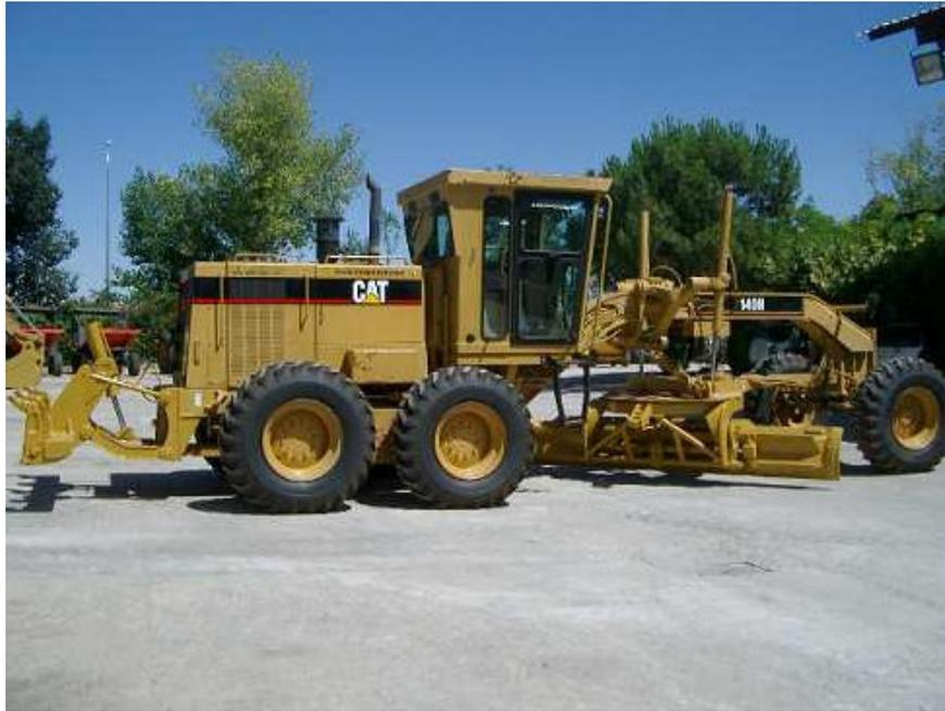
Fig. 1.5 Ilustración de una motoniveladora Cat modelo 140H
