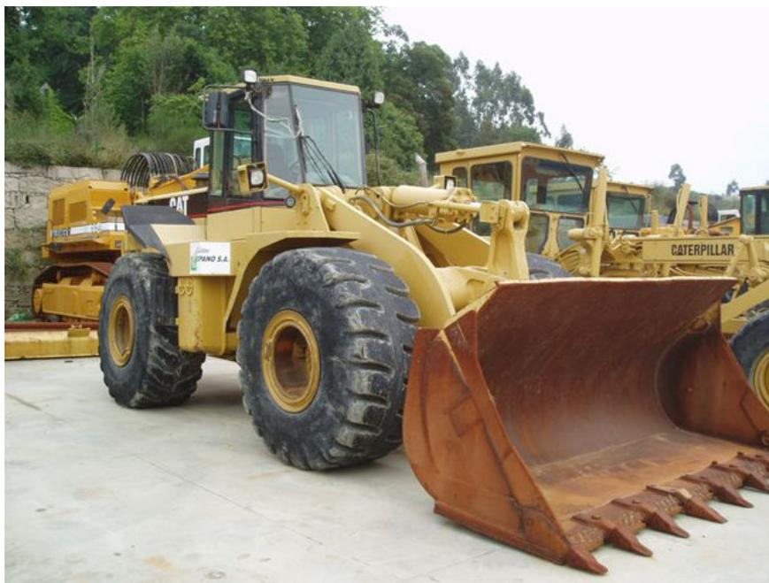
Fig. 1.3 Ilustración de un cargador frontal Cat modelo 950
