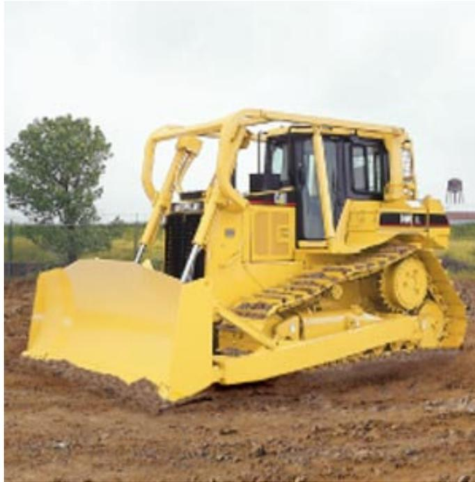
Fig. 1.2 Ilustración de un tractor Cat modelo D6R
