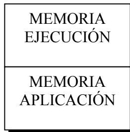
Figura 10. Diagrama de bloques simplificado de la memoria total de un PLC
