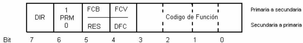
Si la estación A es definida como la estación maestra designada, y la estación B no es una estación maestra, entonces la estación primaria es la generadora del mensaje. La estación secundaria es la estación destino, de lo anterior podemos describir cada bit de control:
