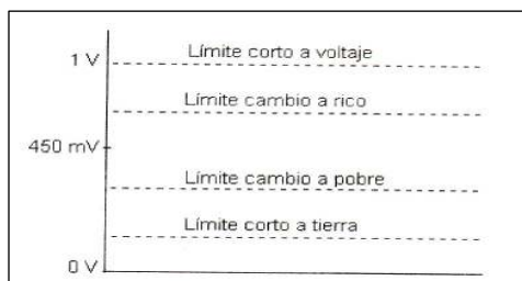
Figura 59. Prueba de voltaje al sensor de oxígeno precalentado
