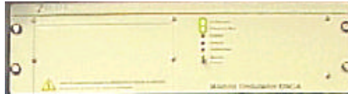
Figura 10. Ondulador de voltaje 48 Vcc/125 ca
