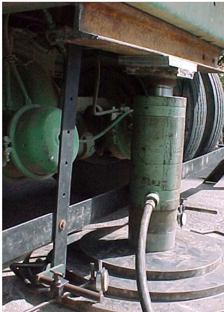
Equipo actual con que se realiza el proceso de análisis de carga con placa estática.
