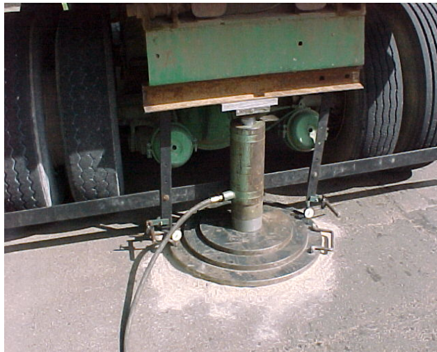
Equipo actual para realizar análisis de carga con placa estática.
