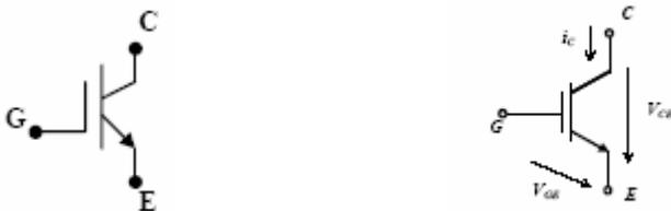
**Estructura del IGBT.** El transistor bipolar de puerta aislada es un elemento semiconductor híbrido que puede verse como un MOSFET controlando a un BJT, con el fin de aprovechar las ventajas de ambos, como se muestra en la figura 38. El IGBT posee un electrodo aislado de control, como en el MOSFET y presenta una baja tensión de saturación como en el transistor bipolar
