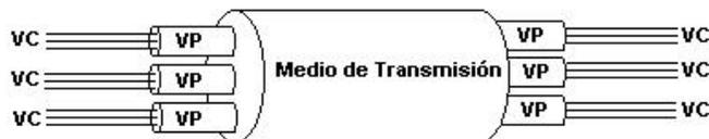
**Estructura de la Transmisión ATM: Múltiples Canales Virtuales (VC) pueden estar multiplexados a través de una misma Ruta virtual (VP) que a su vez son multiplexados a través del medio físico de transmisión.**
