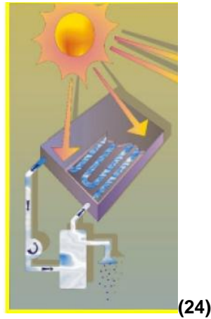
Figura 9.5 Proceso de producción de agua caliente a partir de la energía solar
