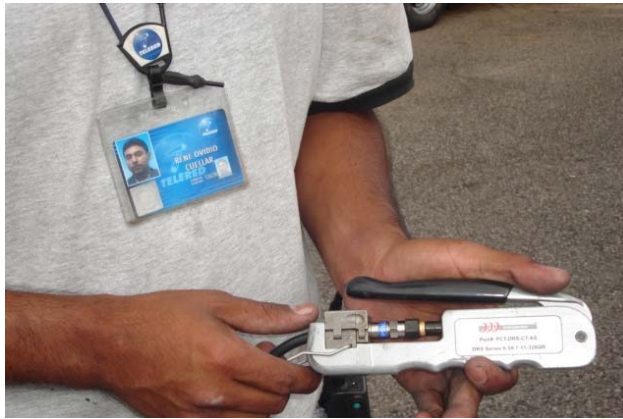
Figura 46. Proceso de colocación de conector
