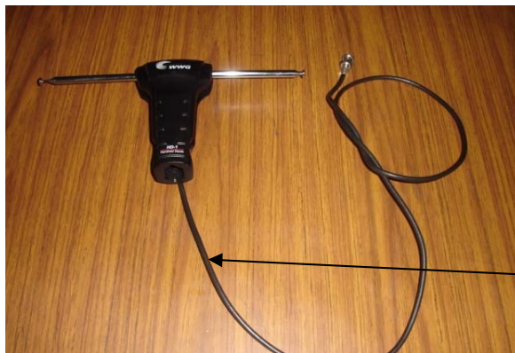
Figura 45. Antena de equipo para detectar interferencias
