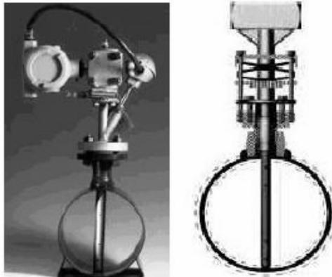
El tubo Annubar es de mayor precisión que el tubo Pitot, del orden de 1%, tiene una baja pérdida de carga y se emplea para la medida de pequeños o grandes caudales de líquidos y de gases.
