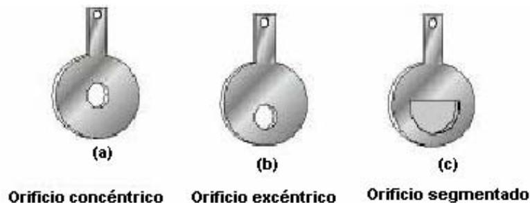
Con el fin de evitar arrastres de sólidos o gases que pueda llevar el fluido, la placa incorpora un orificio de purga como se menciona anteriormente. Entre los diversos perfiles de orificio que se utilizan, según se muestra en la figura 46, se pueden destacar los siguientes: de cantos vivos, de cuarto de círculo y de entrada cónica. La precisión obtenida con la placa de orificio es del orden de  $\pm 1$  a  $\pm 2$  %.
