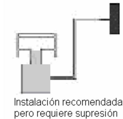
Para la aplicación de un transmisor de presión diferencial a través de un ventilador (figura 70), no permiten el uso de un transmisor de sello remoto, por que los rangos son muy pequeños y usualmente no hay suciedad ni sólidos en suspensión presentes.
