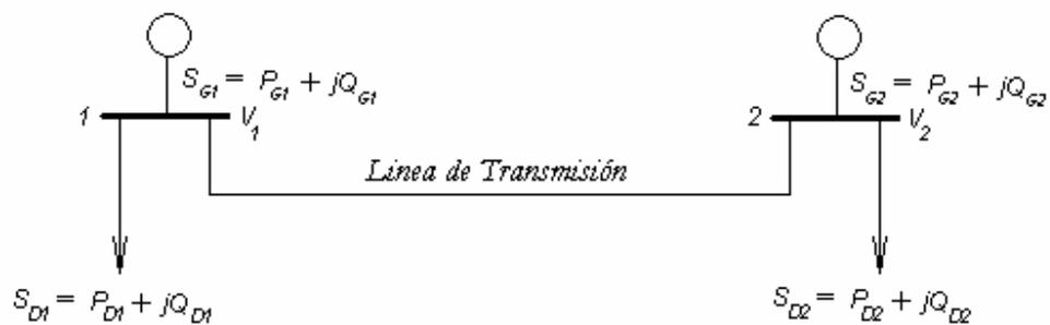
En la figura anterior,  $P_D$  es la potencia activa demandada,  $P_G$  la potencia activa generada,  $Q_D$  la potencia reactiva demandada,  $Q_G$  la potencia reactiva generada y  $S$  la potencia aparente neta.
