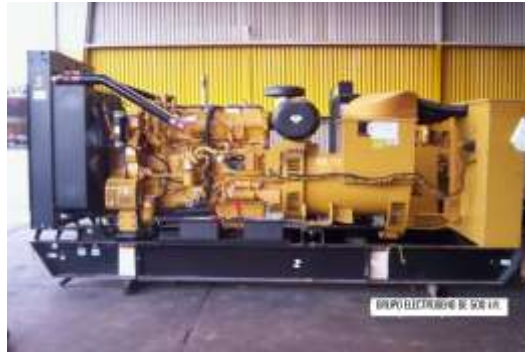
Figura 29. Vista de un grupo electrógeno
