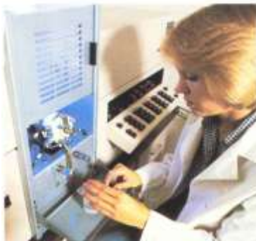
Figura 2. Análisis de una muestra de aceite mediante un Espectrómetro de Absorción Atómica.
