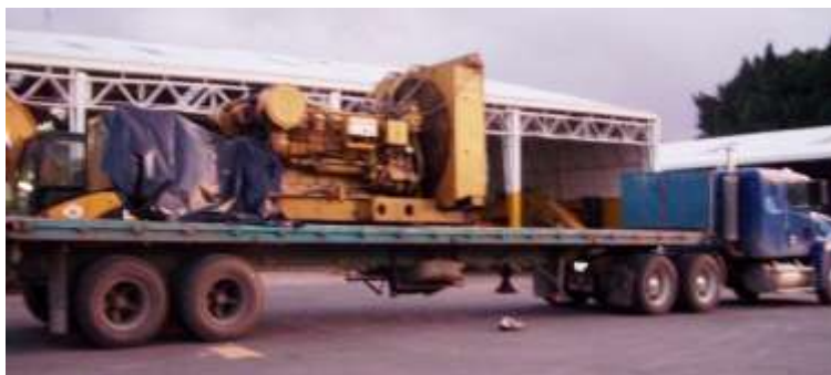
Figura 12. Transporte de un grupo electrógeno
