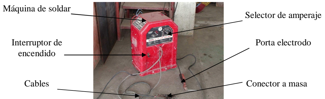
Figura 104 Partes de un equipo de soldadura eléctrica SEA.
