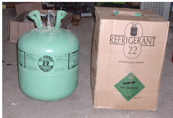
Figura 46 Presentación de cilindros con R-22, los cuales pueden ser de 15, 25 y 35 libras de refrigerante
