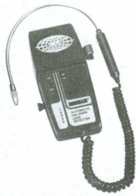
Figura 75 Detector electrónico de fugas
