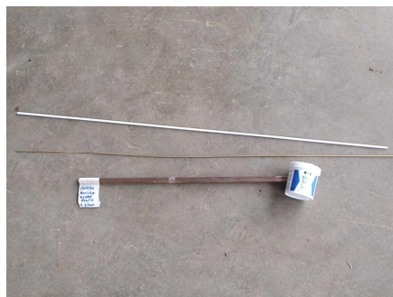
Figura 116 Insumos necesarios en todo momento como herramienta, los cuales son barrillas de plata, de latón y sus correspondientes fundentes.
