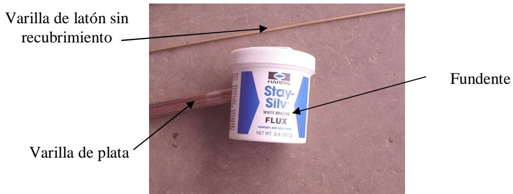
Figura 69 Diferentes insumos para la realización de soldaduras en tubería de cobre L
