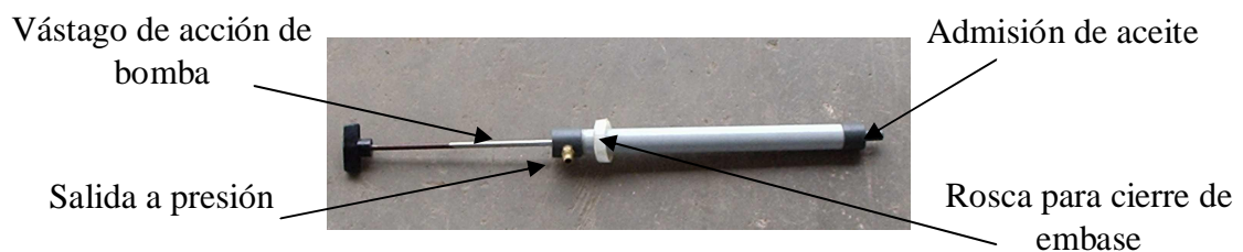
Figura 106 Bomba para carga de aceite plástica de desplazamiento positivo.
