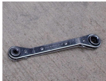
Figura 110 Llave de trinquete de cuatro medidas 3/16, 1/4, 3/8 y 1/2 pulgadas
