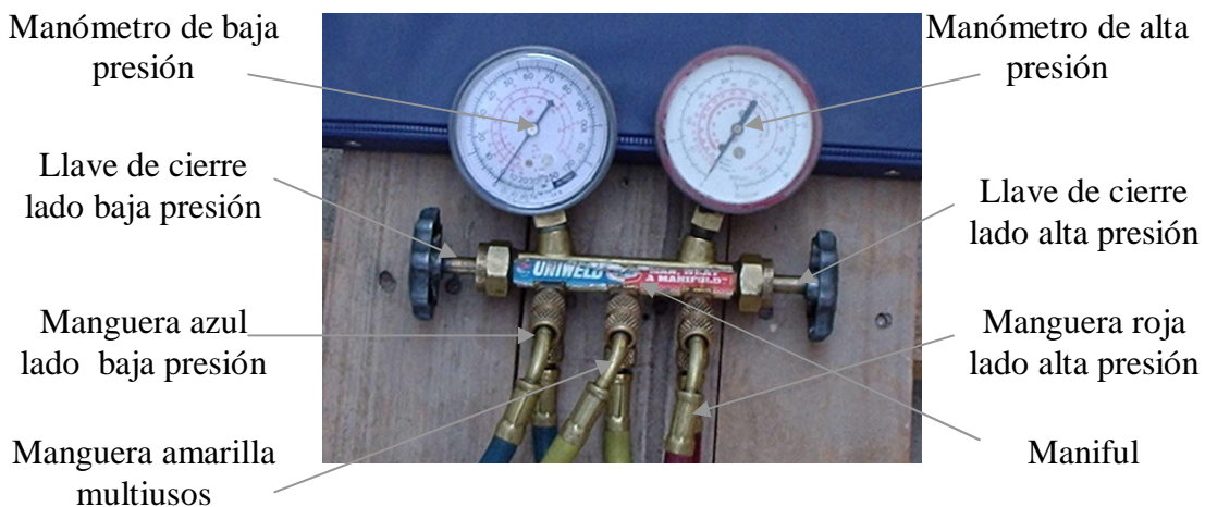
Figura 107 Juego de manómetros para refrigeración
