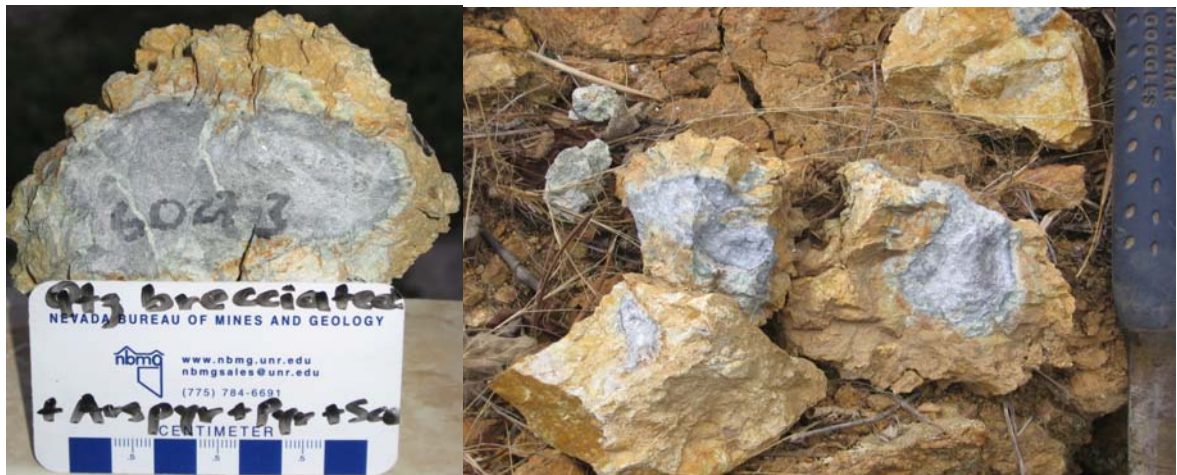
Figura 34. Concentración de sulfuros masivos de arsenopirita en vetas de cuarzo de origen epitermal. Las líneas y coloración en verde claro, corresponden a oxidación del mismo a escorodita.
