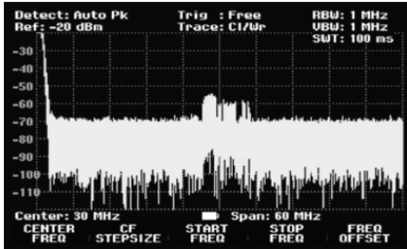
Figura 32. Interferencias observadas con todo conectado
