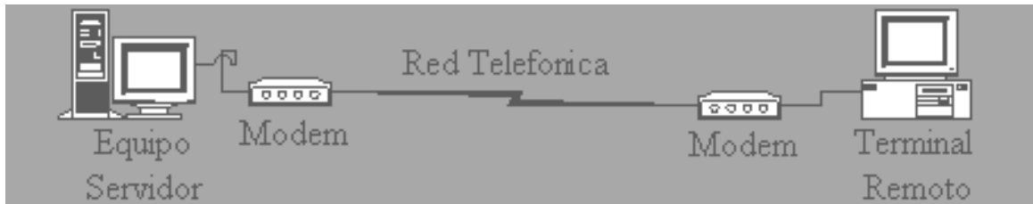
Figura 2. Conexión de una red telefónica al módem
