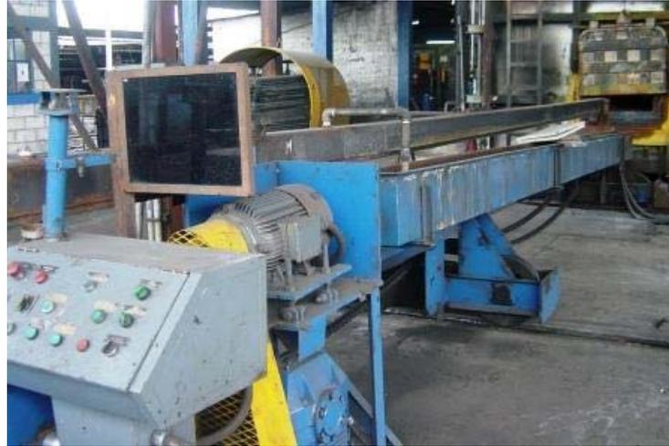
La barra deshornadora, que se muestra en la figura 33, está accionada por un motor trifásico, el cual con un cambio de giro introduce o retira la barra, un pequeño tablero de control tiene el mando para introducir la barra al horno y posicionarla, en sus límites superior e inferior tiene sensores de final de carrera que no permiten que el motor siga más allá de su rango.
