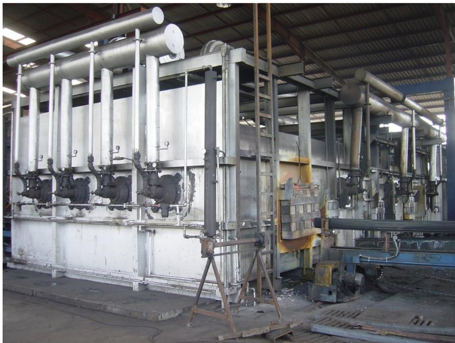
El horno, mostrado en la figura 1, está constituido por una estructura metálica exterior y varias capas de material refractario en el interior diseñadas para trabajo pesado y soportar las altas temperaturas del proceso, así como la expansión térmica, este material refractario debe resistir las condiciones agresivas del horno sin sufrir alteraciones importantes en sus propiedades físico-químicas durante un periodo de tiempo económicamente rentable.
