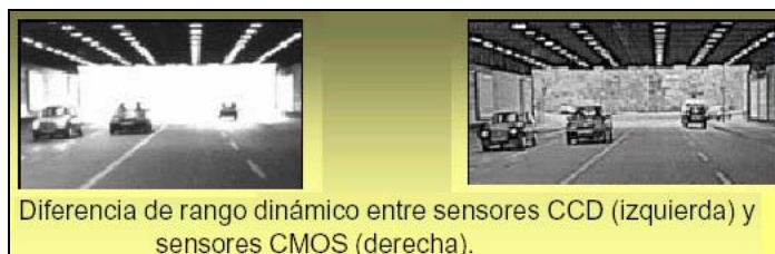
Figura 6. Diferencia entre cámaras CCD y CMOS
