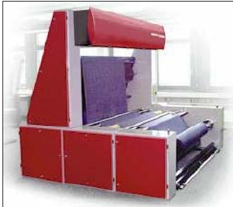
Figura 16. Máquina de inspección Demin, casa USTER
