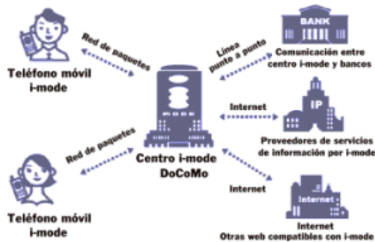
Figura 21: Ilustración del mecanismo de comunicación entre el centro i-mode y un sitio web compatible.
