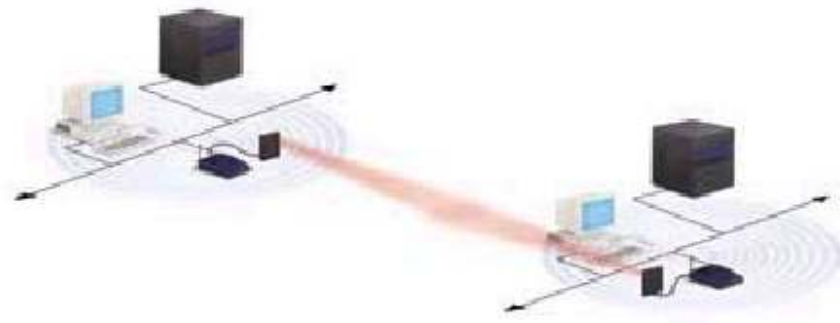
Figura 9: Interconexión de LAN mediante antenas direccionales
