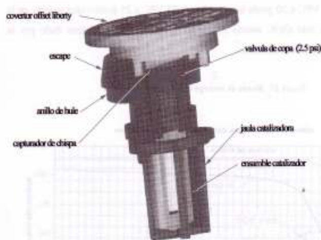
Figura 20. Válvula maximizada de escape, Liberty 2000
