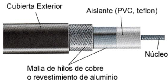
El cable coaxial es más resistente a interferencias y atenuación que el cable de par trenzado.
