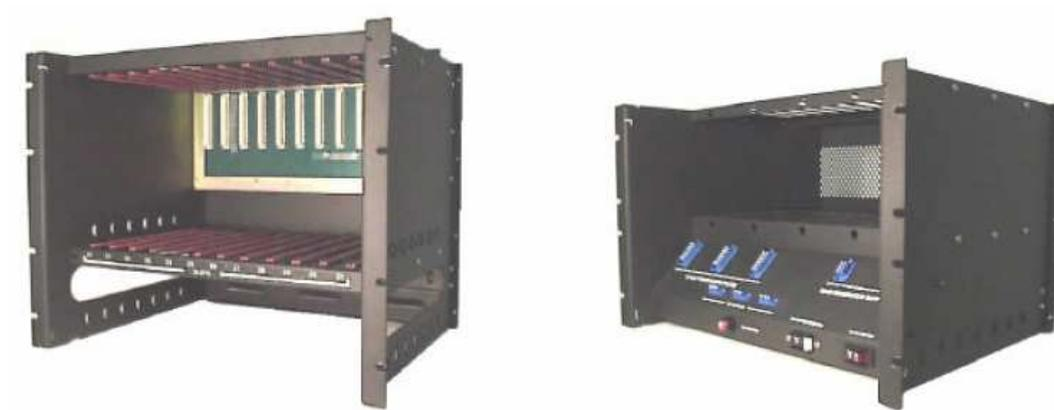
El *backplane* maestro tiene dos tarjetas APU, dos *slots* disponibles para expansiones y 8 tarjetas de suscriptores para un total de 256 puertos. Cuando se necesite realizar ampliaciones a 640 puertos puede adherirse un segundo *backplane* con el cual tendrán dicha capacidad, de la misma forma para aumentar el sistema a 1024 puertos pueden adherir un tercer *backplane*.
