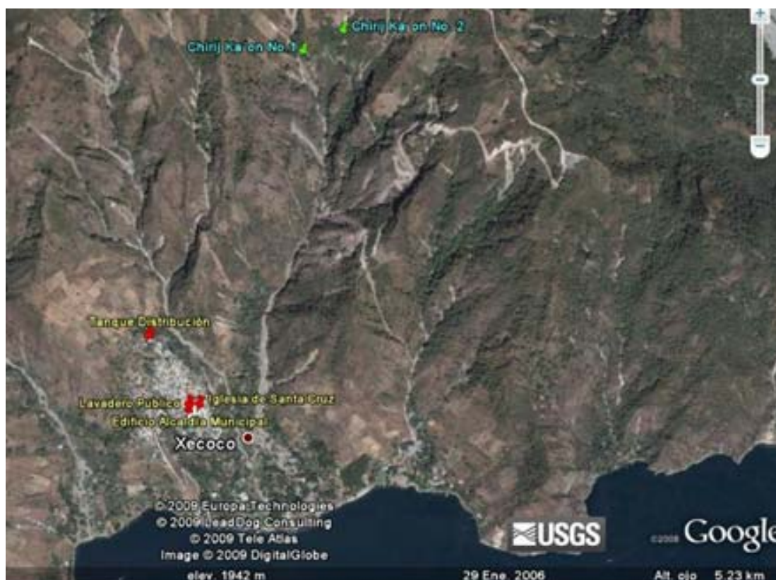
Gráfica 13: Muestra la ubicación de los nacimientos Chirij Kaón No. 1 y No.2, tanques de distribución e instalaciones municipales. El desnivel que hay hacia el tanque de distribución es de 320 metros. Foto satelital Google Earth.
