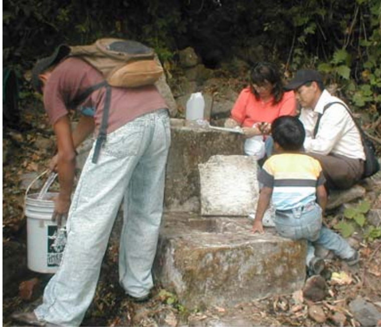
Gráfica 15: Milagro Fajardo acompañada de personal de la municipalidad de Santa Cruz La Laguna, en el momento de medir caudal. Se puede apreciar la cubeta utilizada en el tubo de descarga de la caja de captación en nacimiento Chirij Ka´on No. 1. Foto: Erick González
