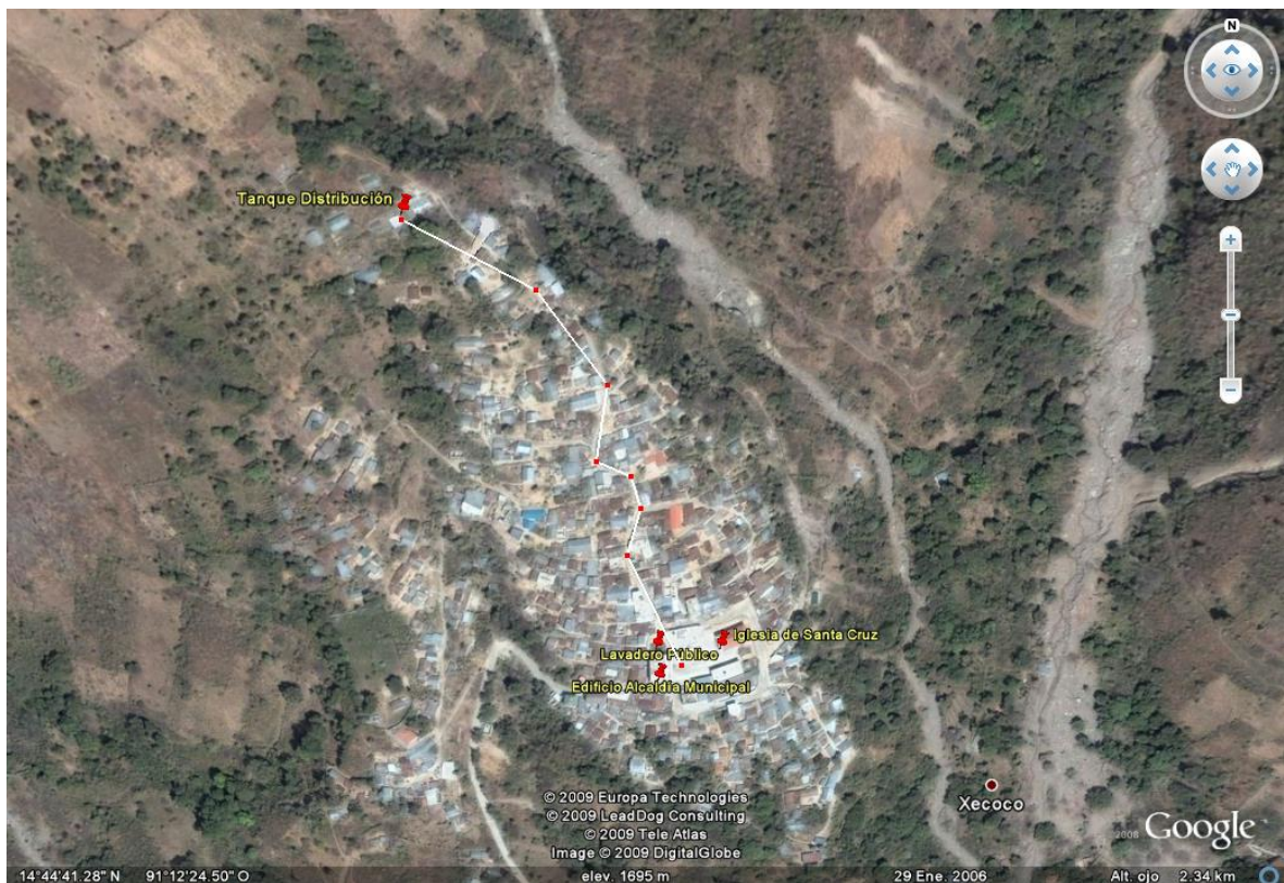
No. 41: Aprovechamiento hidroenergético del sistema de distribución de agua de Santa Cruz La Laguna para iluminar plaza central y/o lavadero público
