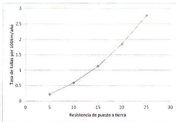
Figura 1. Variación de resistencia de puesta a tierra.
