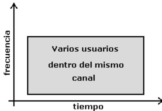
CDMA utiliza códigos pseudo aleatorios los cuales se multiplican por la señal que contiene la información, codificando de esta manera los datos de banda base antes de la transmisión. La señal es transmitida en un canal el cual esta debajo del nivel del ruido.
