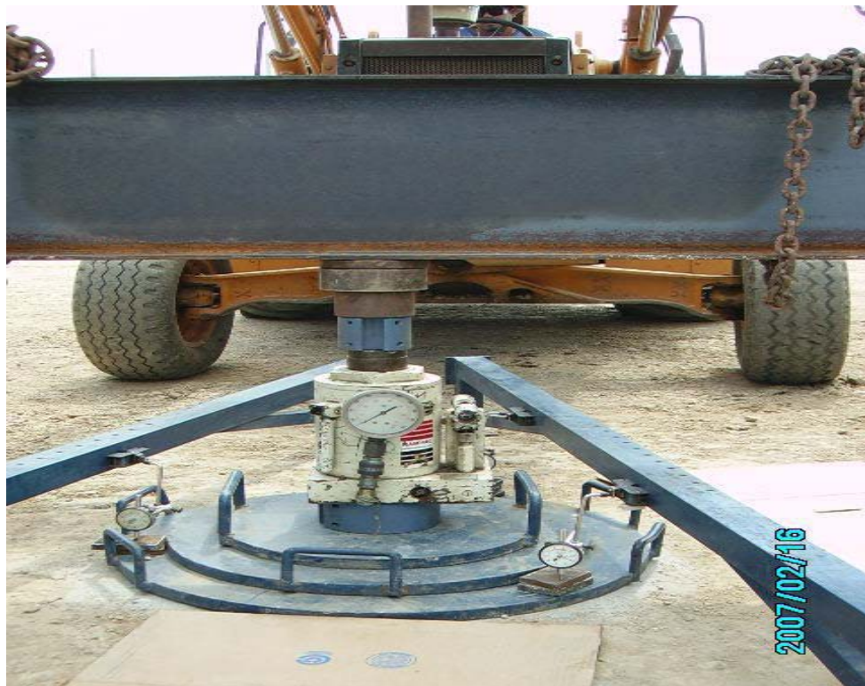
Prueba de placa para determinar el modulo de elasticidad.
