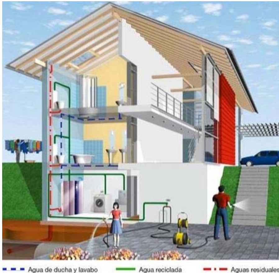
Figura 10. Separatividad de las aguas en una vivienda
