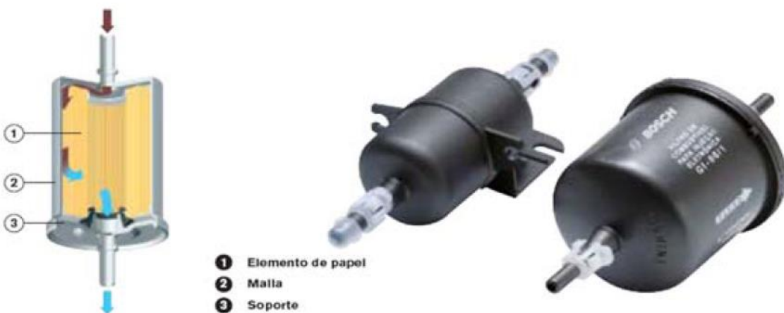
Figura 9. Filtro de combustible
