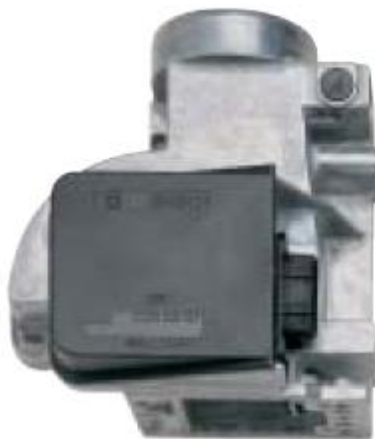
Figura 14. Medidor de flujo de aire
