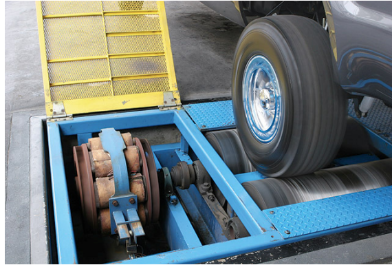
Figura 7. Dinamómetro de Chasis con rodillos, sistema de frenado.
