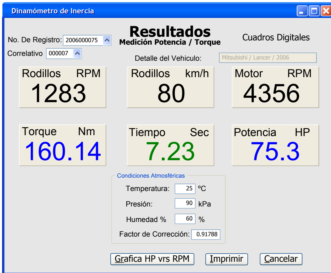
Figura 50. Resultados sobre la medición de Potencia y Torque, según datos guardados en base de datos. Ventana de Cuadros Digitales.
