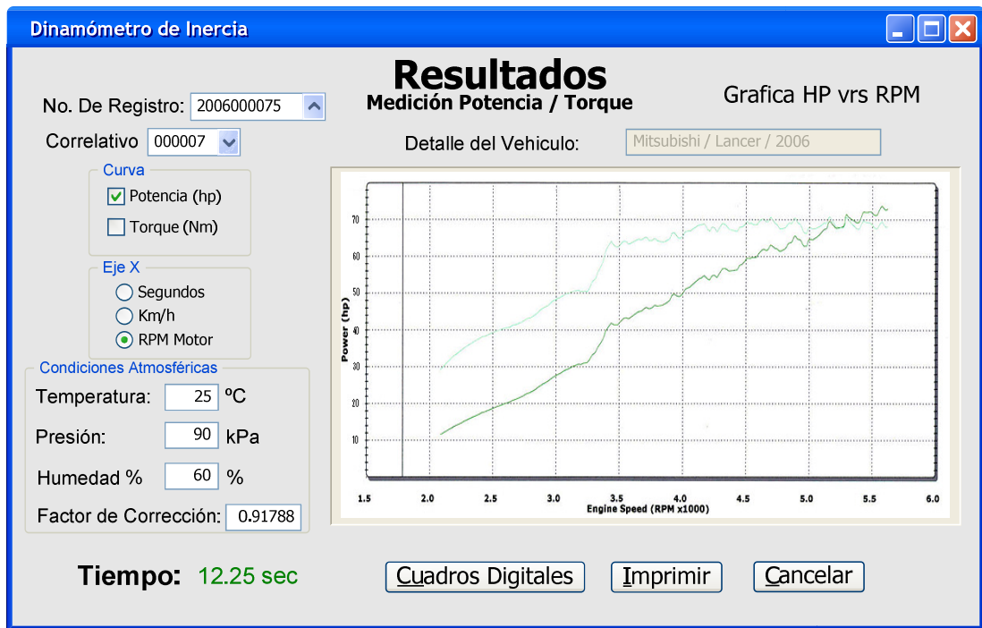
Figura 51. Resultados sobre la medición de Potencia y Torque, según datos guardados en base de dato. Ventana de Gráfica HP vrs RPM.
