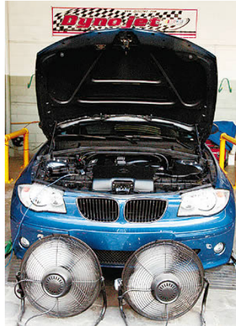
Figura 14. Sistema de ventilación, al momento de la prueba con el dinamómetro.
