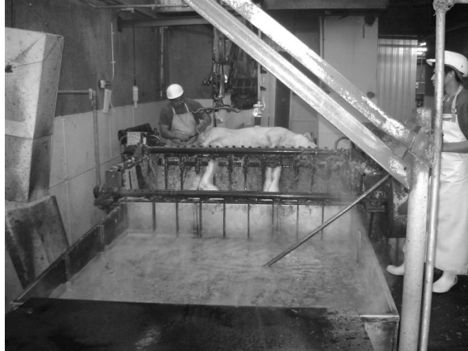
FIGURA 6. TANQUE DE ESCALDADO Y DEPILACIÓN
