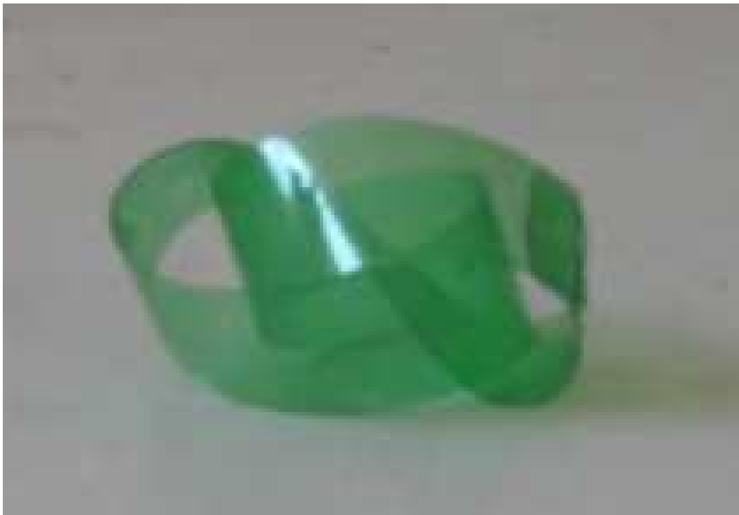
IMAGEN 10: Elemento filtrante diseñado a base de desechos PET
