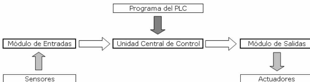
Componentes del sistema de un PLC.
