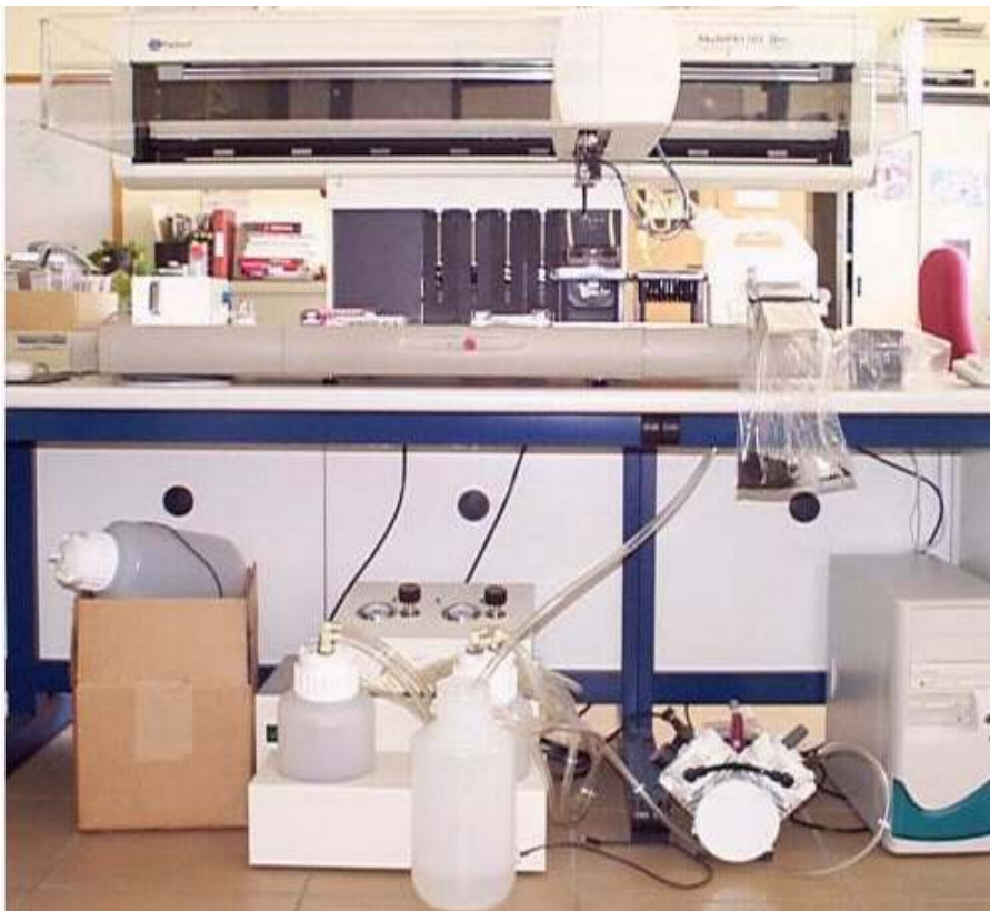
Figura 15. Robot multipeteador para manejo de líquidos, Multiprober II de Perkin-Elmer
