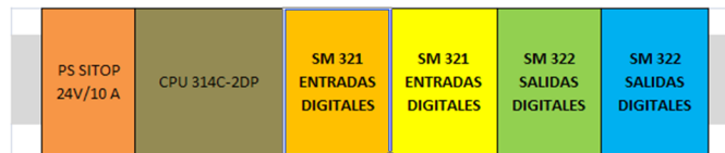
Figura 105. Posición de módulos en el rack
