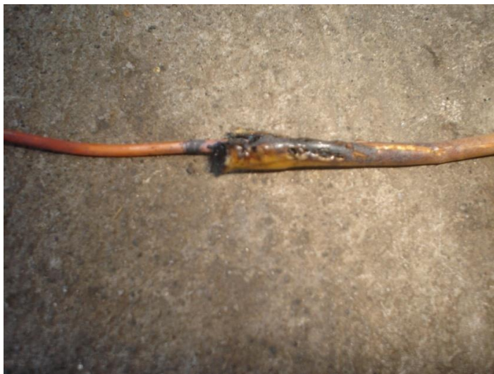
Figura 11. Aislante con ahuecamiento o separación por sobrecarga
